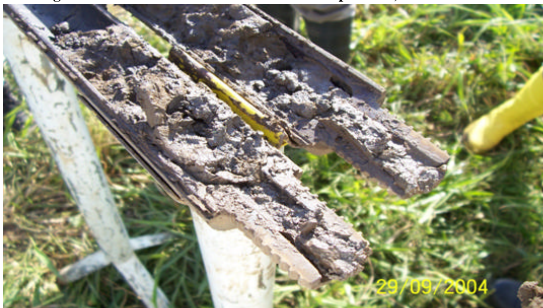
Fotografía 4. SA10-S1. Suelo contaminado con petróleo, 0.85 a 1.70 metros
