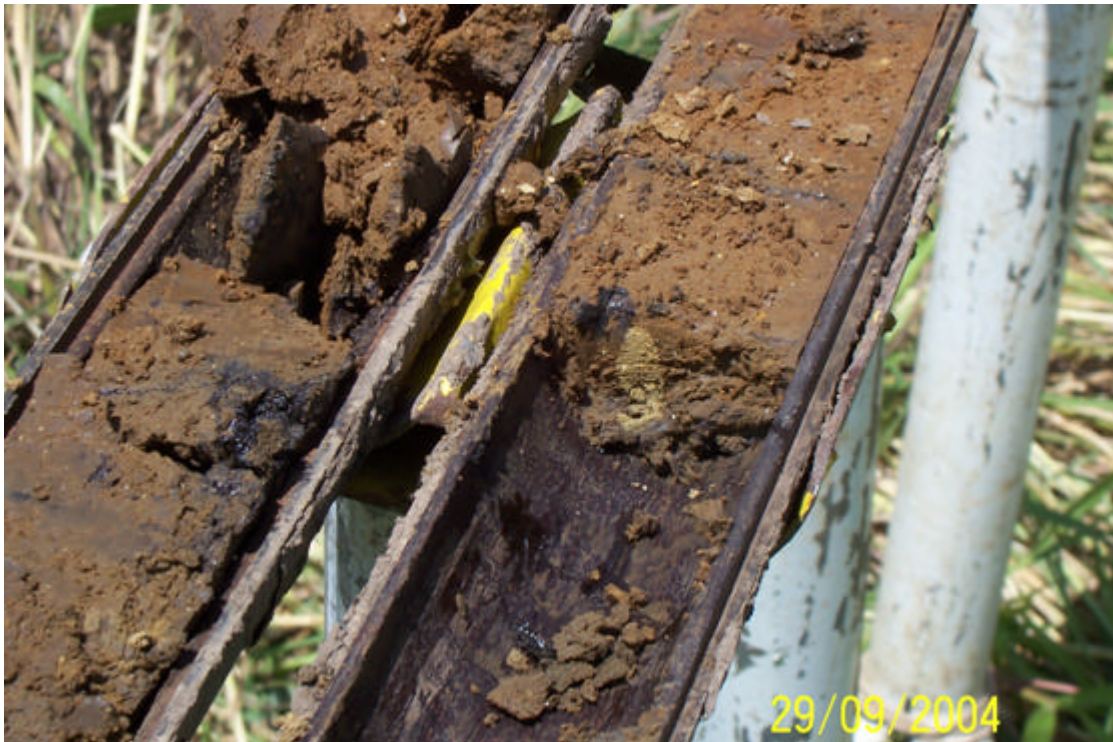
Fotografía 12. SA10-SE2. Tramo contaminado con crudo, 0.50-1.35 metros
