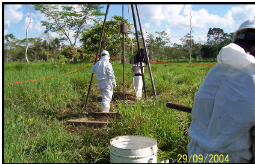
Fotografía 3. Equipo en maniobra de perforación de hoyo de muestreo
