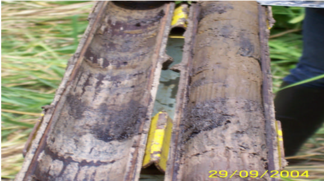
Fotografía 10. SA10-SE2. Tramo contaminado con crudo, 0.50-1.35 metros
