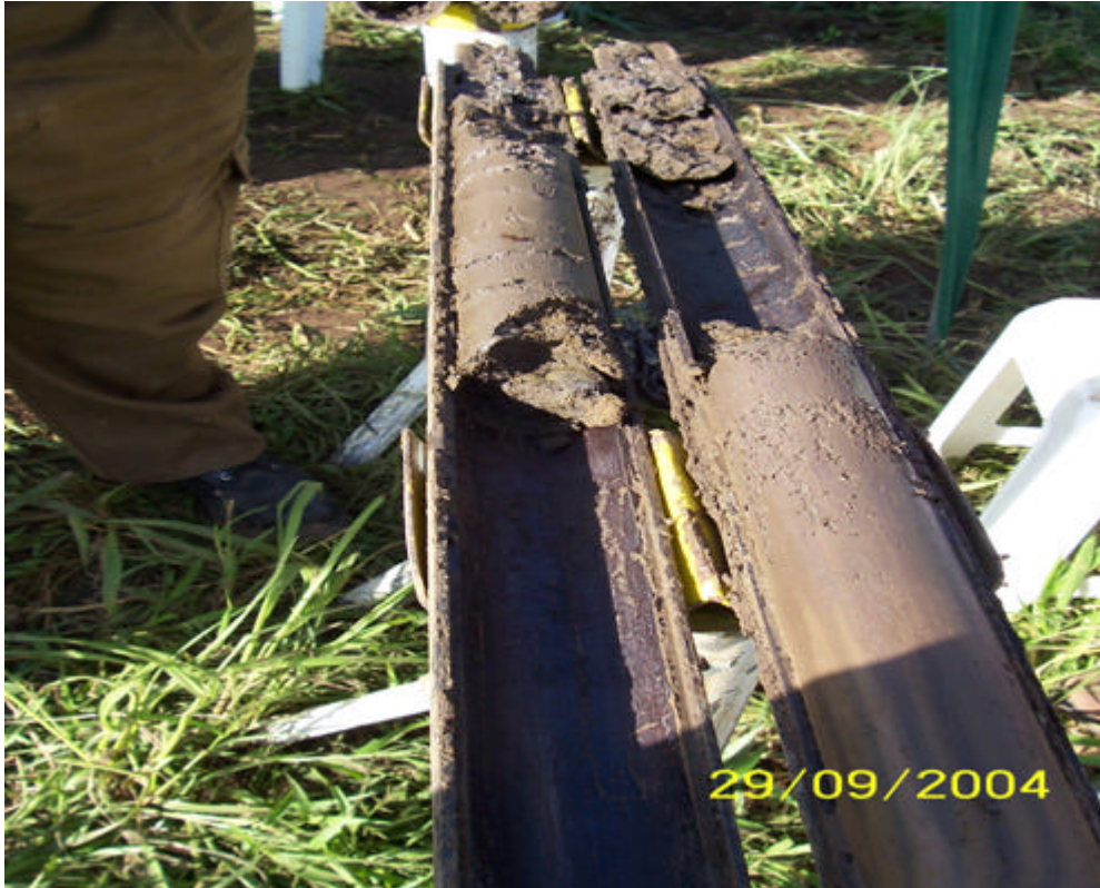
Fotografía 5. SA10-S1. Tramo contaminado con petróleo, 0.85 a 1.70 metros
